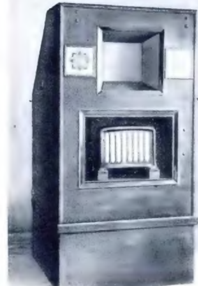
Ein Telefunken-Karolus-Fernsehempfänger für Vorführungszwecke. Das Bild erscheint auf der oben vertieft angeordneten Mattscheibe, und der Lautsprecher gibt die akustische Sendung wieder.
